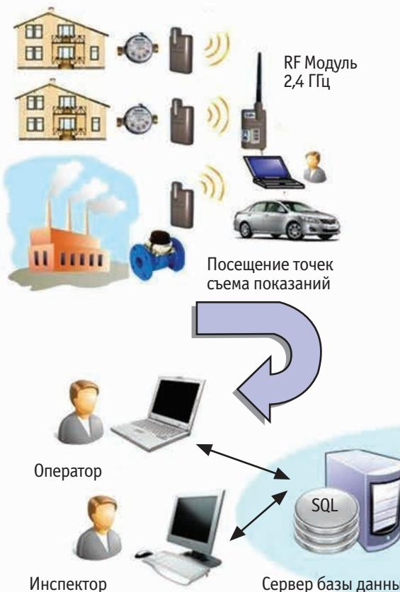
Смысл ручного способа состоит в том, что оператор по заранее полученному заданию (маршрут обхода) производит обход абонентов, указанных в задании. Данные с радиомодулей автоматически сохраняются в компьютере оператора, после чего они записываются в базу данных сервера. Доступ к показаниям, занесенных в базу данных, возможен как для потребителя, так и для поставщика посредством интернет соединения с использованием любого WEB – браузера.
