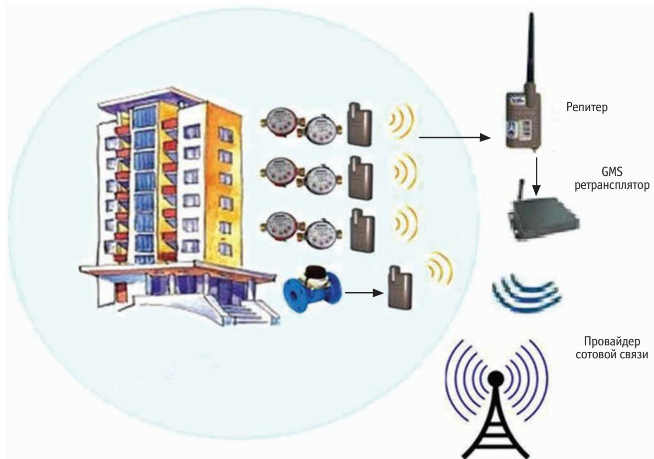
GSM ретранслятор необходим для передачи данных, полученных от радиомодулей (напрямую или через репитер) на сервер, через провайдера сотовой связи. После чего информация автоматически записывается в базу данных сервера. Доступ к показаниям, занесенным в базу данных, возможен как для потребителя, так и для поставщика посредством интернет соединения с использованием любого WEB – браузера.
