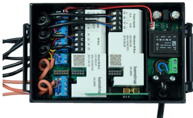
Модуль Wireless M-Bus с внутренней антенной
