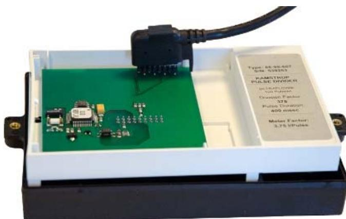
Рис. 65. Расположение 8-контактного разъема в делителе импульсов 66-99-607.
