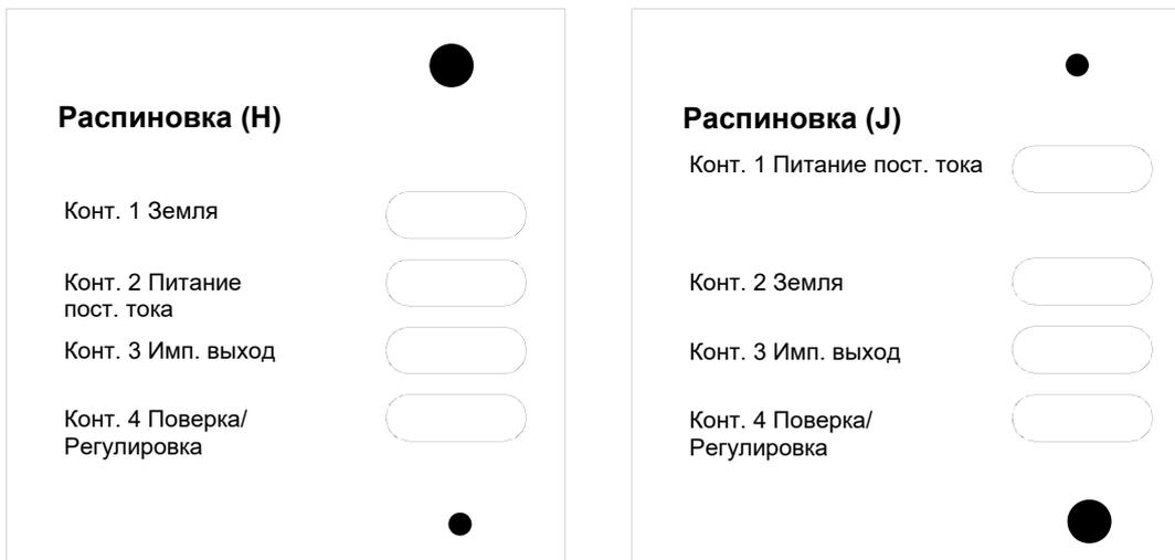
Рис. 44. Разводка выводов ULTRAFLOW® 54 (H)/(J).
