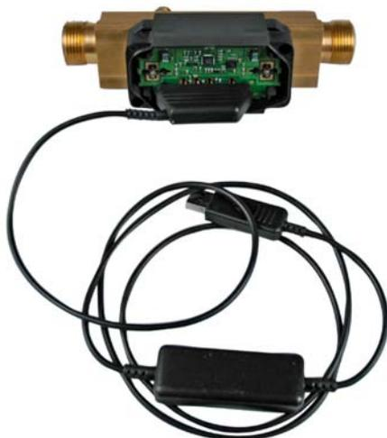
Рис. 59. Расположение 4-контактного разъема в ULTRAFLOW® 54.
