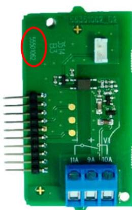
Рис. 40. Гальванически развязанный модуль вывода (Y=2).
