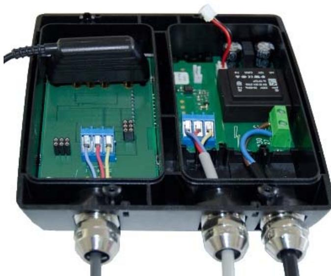
Рис. 66. Расположение 4-контактного разъема в делителе импульсов 66-99-907.
