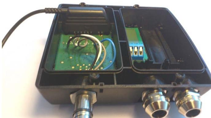
Рис. 64. Расположение 4-контактного разъема в ULTRAFLOW® 54 DN 150...300.
