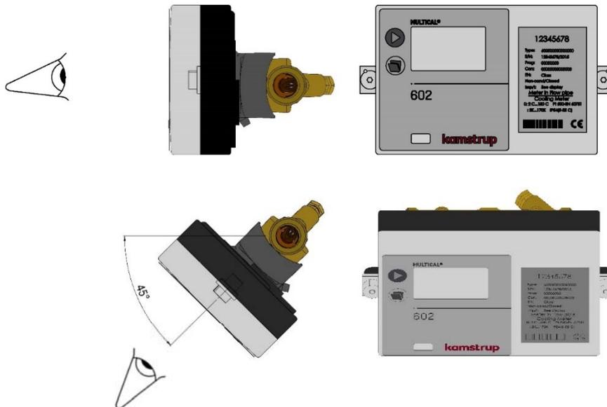
Рис. 14. MULTICAL®, смонтированный на ULTRAFLOW® 54, установленном горизонтально на уровне глаз или выше
