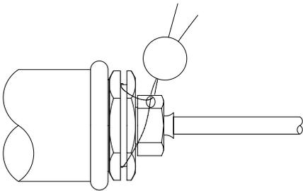
Пломбирование датчика, установленного в гильзе.
