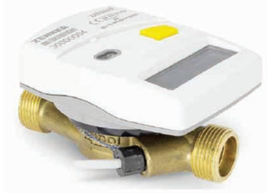
Теплосчетчики выпускаются **номинальными расходами** 0,6 м<sup>3</sup>/ч или 1,5 м<sup>3</sup>/ч или 2,5 м<sup>3</sup>/ч и **присоединительными размерами** DN15 (0,6 м<sup>3</sup>/ч или 1,5 м<sup>3</sup>/ч) и DN20 (2,5 м<sup>3</sup>/ч)
